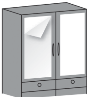
飛散防止フィルムの張り付け
